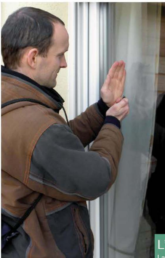
En plaçant une flamme devant le vitrage, le technicien observe les quatre reflets dans le verre. Leur couleur permet de juger de la qualité de l'isolation thermique. (Par ailleurs, en estimant l'espacement des flammes on pourrait aussi évaluer l'isolation acoustique).
