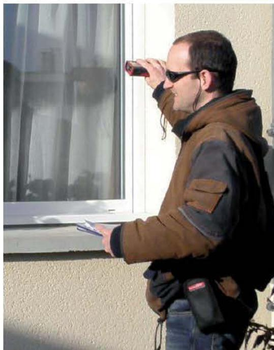
Le technicien évalue la dimension de la fenêtre au moyen d'un laser mètre.
